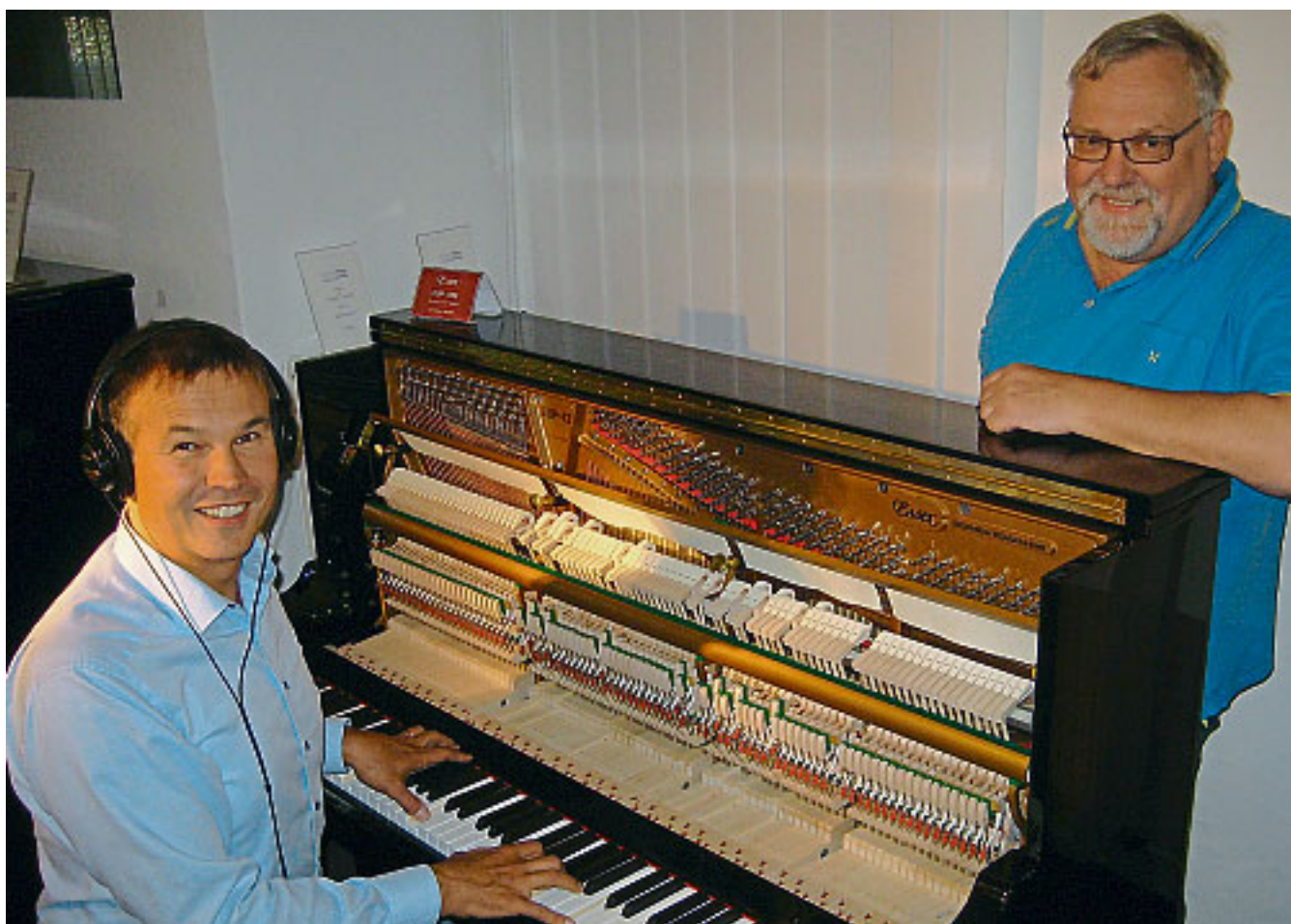
Klavierbaumeister Rudolf Micke (l.) hat die Stummschaltung aktiviert. Innungs-Obermeister Klaus Diekers hört keinen Ton, obwohl sich die Hämmer des Klaviers ganz normal bewegen.
